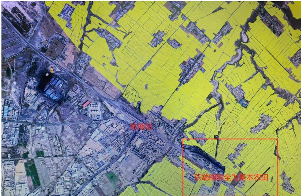
为避免占用基本农田，将下行到发场设置在张掖站以西。张掖站西端线路最大纵坡为 6%，长度约 5km，具备增设到发场条件。在张掖站西端下行方向（线路南侧）新设下行到发场。到发场从区间 K515+808 出岔，以 5% 的下坡引出，在兰新线南侧设下行到发场，到发场设 4 条到发线（兼顾机走线），单线有效长 880m，到发线有效长范围内为平坡，有效长范围外以 6% 下坡继续向西，最终在区间 K518+508 处接入兰新正线，新设下行到发场站坪长度约 2700m。新设下行到发场两端咽喉区各设机待线 1 处，有效长 150m，东段咽喉与与捷安物流专用线连通，减小
